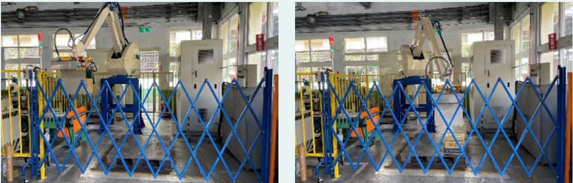
改善後：購置機械手臂取代人工搬運
